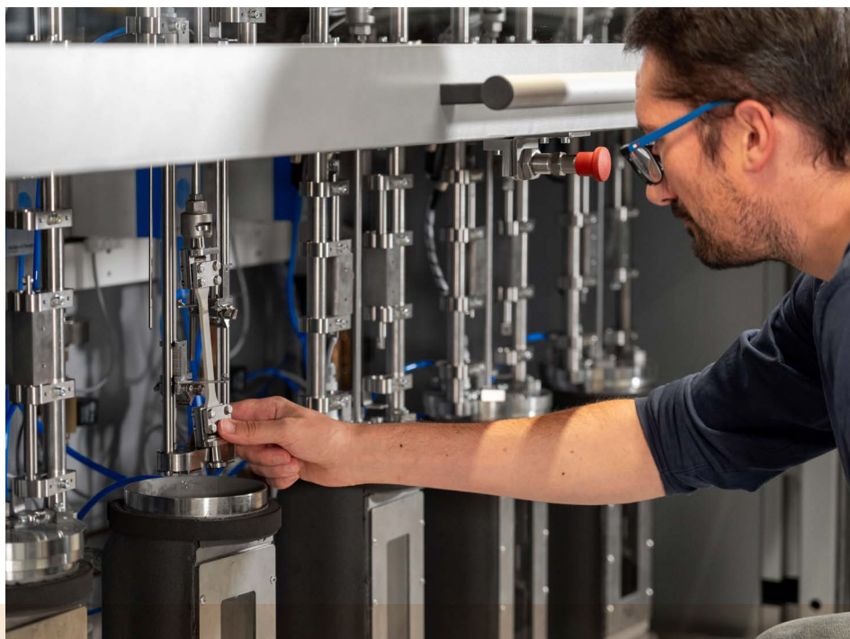
Neue Prüfanlage zur Ermittlung des Einflusses von Medien auf die Spannungsrisssbeständigkeit von Kunststoffen am SKZ. (Foto: Luca Hoffmannbeck, SKZ)
