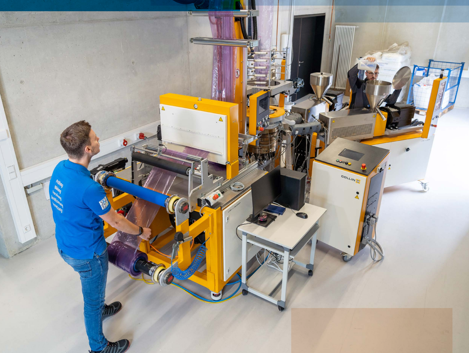
Blasfolienanlage am SKZ (Foto: Luca Hoffmannbeck, SKZ)
