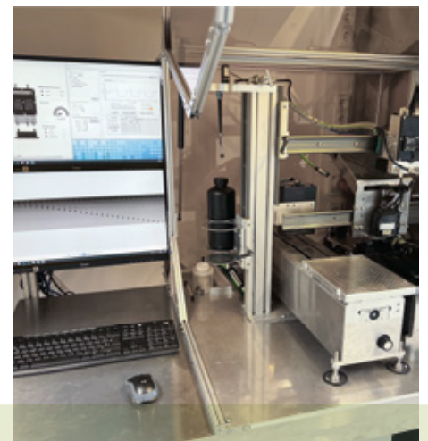
Inkjet-Drucker zur Erprobung der CNT-Tinte (Foto: SKZ)
