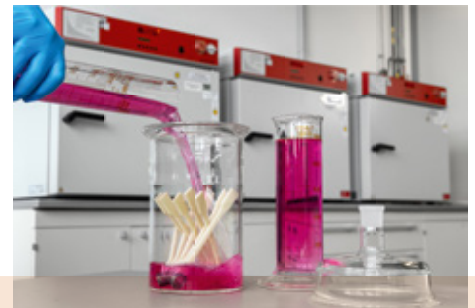
Einfüllen eines Mediums für Beständigkeitsuntersuchungen. (Luca Hoffmannbeck, SKZ)
