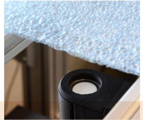
Ultraschallwandler bei der Prüfung eines extrudierten Kunststoffschäumens. (Foto: SKZ)
