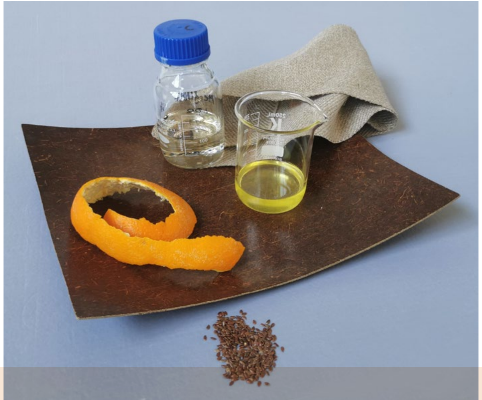
Naturfaserverstärktes Composite auf Basis von Leinöl- und Limonen-Epoxidharz (Foto: SKZ)
