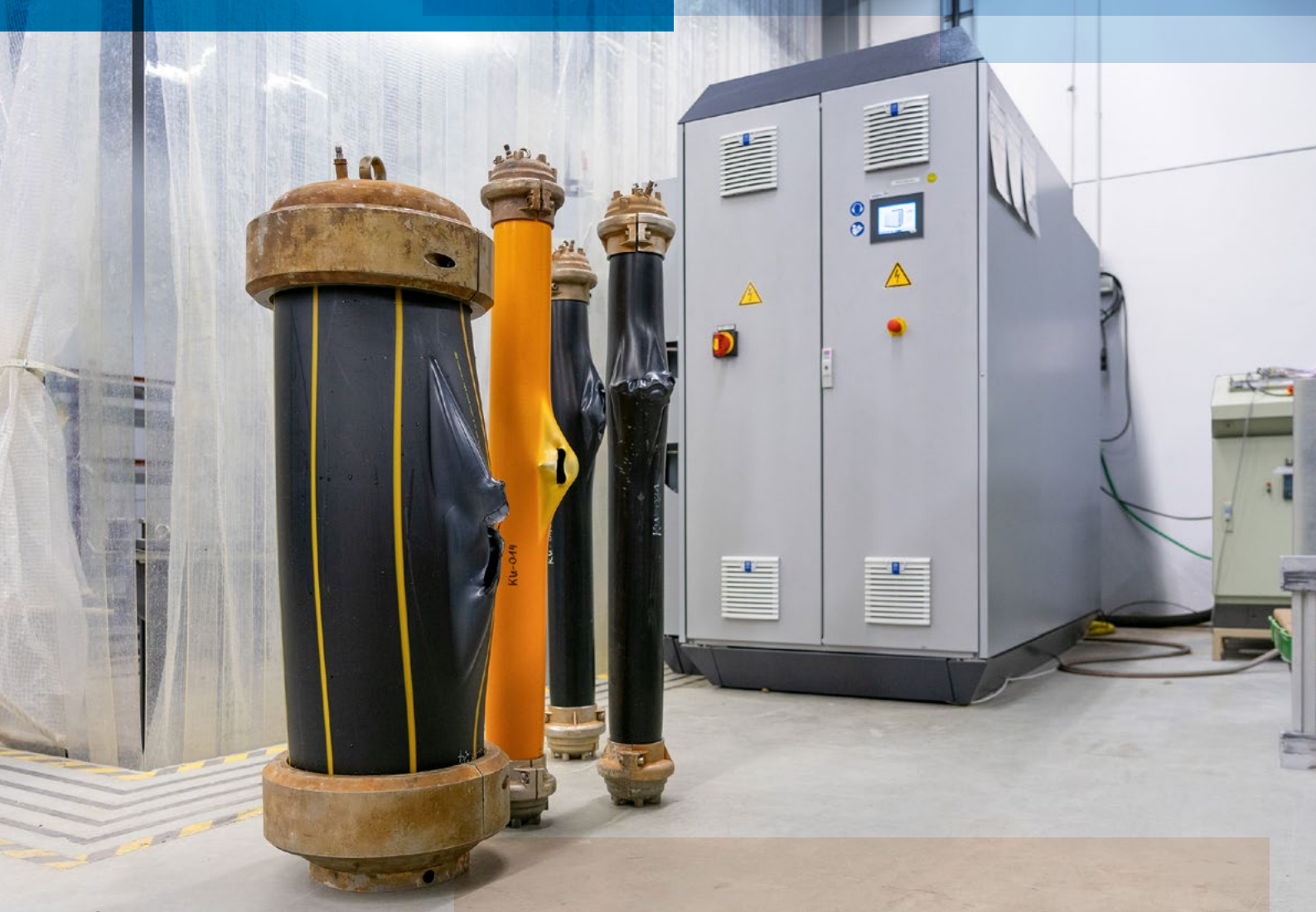
Geprüfte Rohre vor dem neuen Großrohr-Berstprüfgerät. (Foto: Luca Hoffmannbeck, SKZ)
