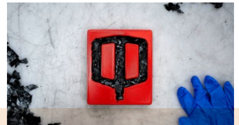
Im Forschungsprojekt „PreCycle“ werden hochwertige Fahrradpedale aus nicht verwendeten Materialverschnitten hergestellt. (Foto: all ahead composites GmbH)
