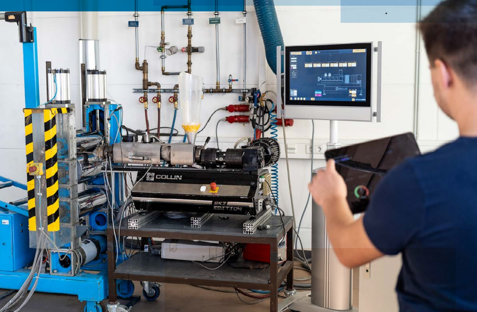
Virtueller Produktions-Assistent (Vipra®) im Einsatz an einem Labor-Doppelschneckenextruder. (Foto: SKZ)
