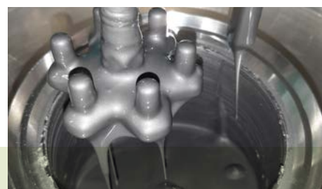
Herstellung von Batterie-Suspensionen mithilfe eines Mischers. (Foto: EZD?)
