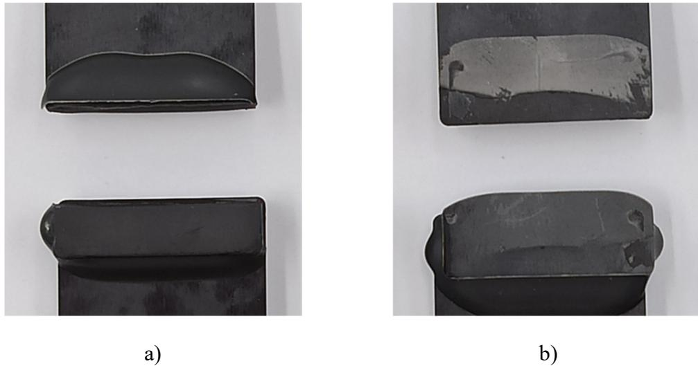
Abbildung 5-22: Bruchbilder von PP R1-Klebverbindungen mit dem Klebstoff AD840.
