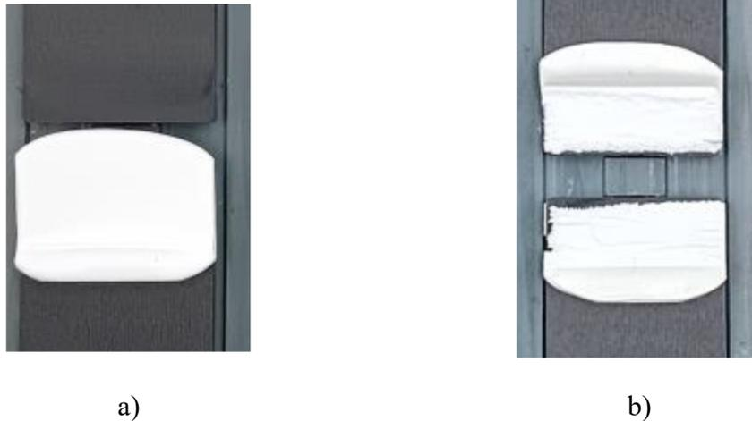
Abbildung 5-32: Bruchbilder von PA6.6 R1-Klebverbindungen mit dem Klebstoff Sikaflex.
