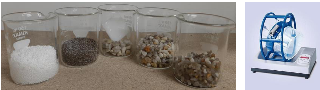
Abbildung 46: links) Für Partikelfreisetzung untersuchte Abriebskörper: v.l.n.r.: Zirkonoxid-Mahlkörper, Stahlkugeln, 3 fraktionierte Steinschüttungen; rechts) definierte Belastung in einer Röhrrad-Trommel mit den unterschiedlichen Abriebskörpern (Bild von https://www.hornik.eu.com/ ).
