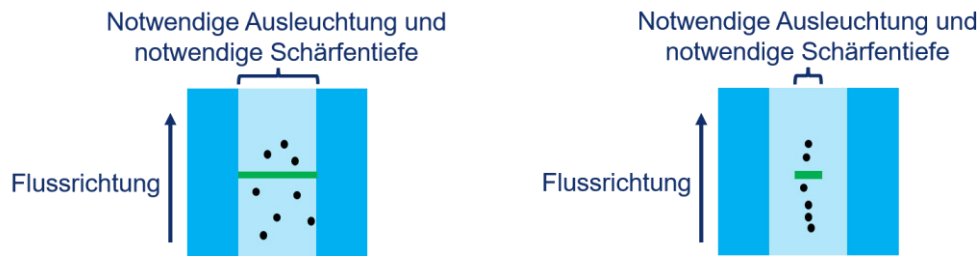
Abbildung 44: Vorteile durch die Fokussierung der Partikel mittels Ultraschalls.
