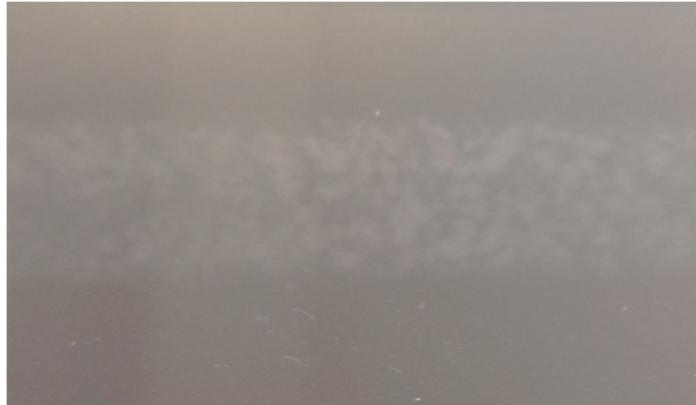
Abbildung 15: Fotografie einer PP-Oberfläche nach der ADP-Vorbehandlung mit einem Behandlungsabstand von 8 mm und einer Behandlungsgeschwindigkeit von 50 mm/s. Durch die Vorbehandlung entstand ein unregelmäßig heller gefärbter Bereich auf der schwarzen PP-Oberfläche.
