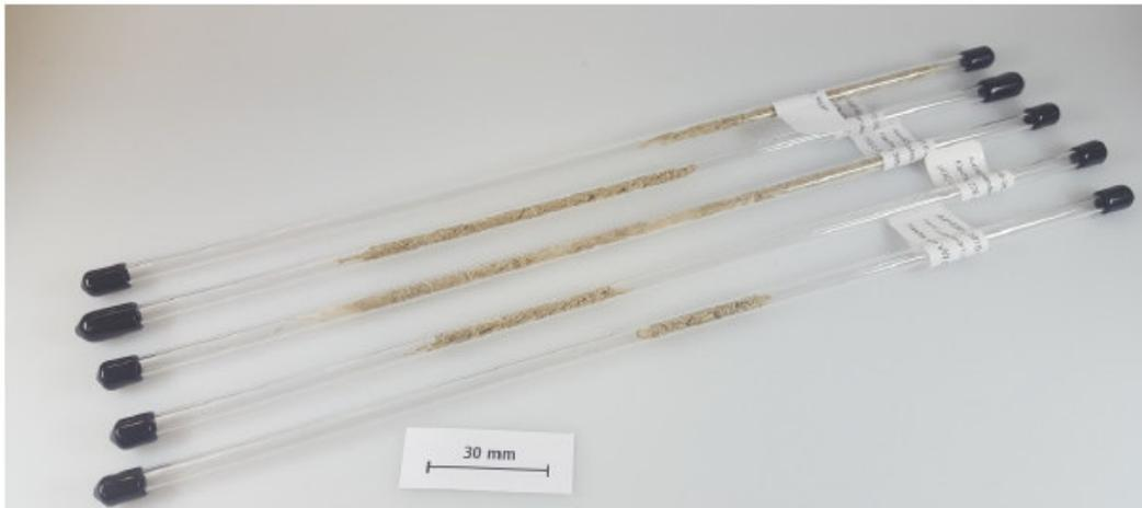
Abbildung 11: Beispiele für die in den Untersuchungen verwendeten iGC-Säulen.
