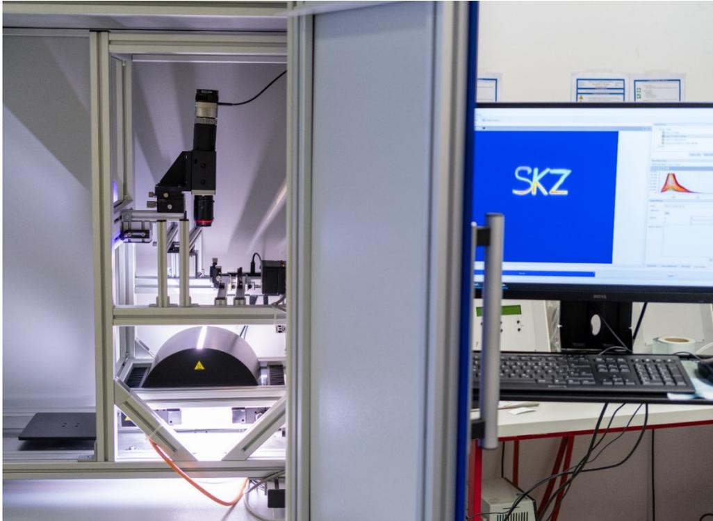
Abbildung 12: Der für die Versuche eingesetzte Laser-HSI-Aufbau.
