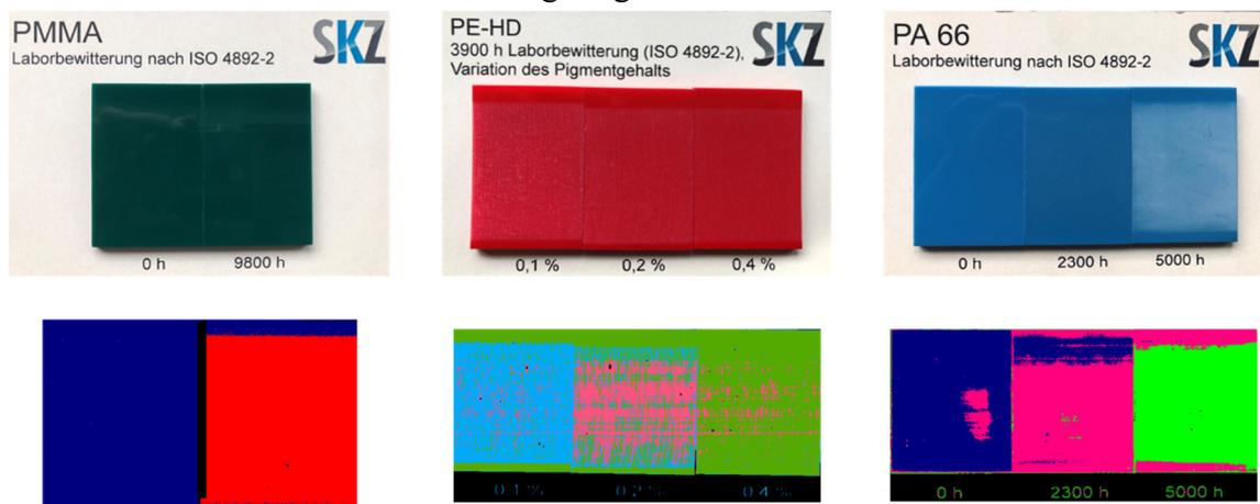
Abbildung 52: Bewitterte Probekörper aus PMMA, PE-HD und PA 66 (oben) sowie die Klassifizierung der unterschiedlichen Bewitterungszustände (unten).
