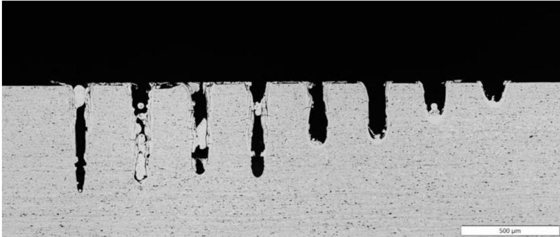
Abbildung 11: Schliffbild einer Laserstrukturierten EN AW 5754 Probe, Laserleistung 2,5 kW, Überfahrten variiert zwischen 8 und 1 von rechts nach links
