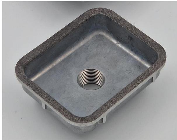
Abbildung 59: Laserstrukturierter Aluminiumkörper eines Druckprüfkörpers
