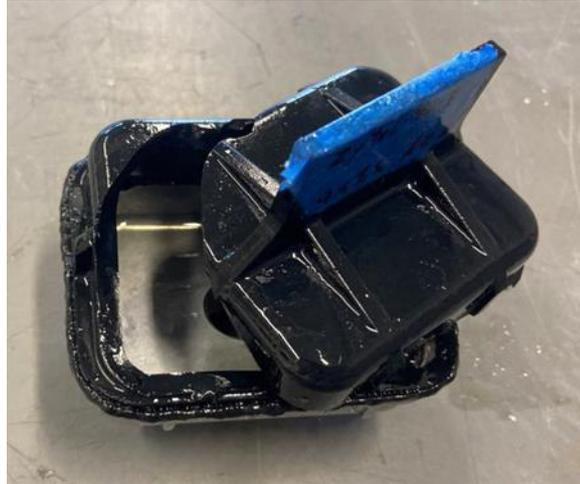
Abbildung 62: Getesteter Berstdruckprüfkörper mit Versagen im Grundwerkstoff, Material: EN AC 43000 / Zytel 103 (PA66)
