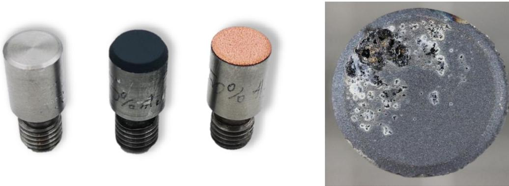
Abbildung 32: v.l.n.r. unbeschichtetes Heizelement, TiO<sub>x</sub> beschichtetes Heizelement, TiO<sub>x</sub> + Kupfer beschichtetes Heizelement; beschädigte Oberfläche eines Heizelements infolge der Ausbildung von Lichtbögen zwischen Werkzeug und Werkstückoberfläche (rechts)
