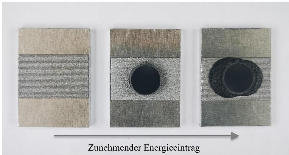
Abbildung 34: Fügebilder mit steigendem Energieeintrag von links nach rechts: keine ausreichende Anbindung (links), angestrebtes Fügebild mit leichtem Schmelzaustritt (mittig), zu hoher Energieeintrag mit starkem Schmelzaustritt (rechts), Material: EN AW 5754 / PA66GF30
