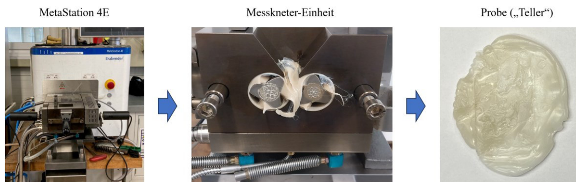
Abbildung 15: Probenherstellung mittels Messkneteter. (Links) MetaStation 4E mit Messkneteter-Einheit W50. (Mitte) PE-Marker Compound in der Messkneteter-Einheit. (Rechts) Fertige Probekörper/Teller.
