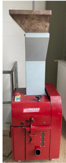
Abbildung 19: Schneidmühle MB 2121, Wittmann Battenfeld GmbH.
