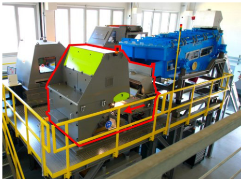
Abbildung 16: Links: Sortieranlage im Pilotmaßstab am Fraunhofer IWKS, rot markiert sensorbasierte Sortiereinheit. Rechts: Prinzipskizze der sensorbasierten Sortierung.
