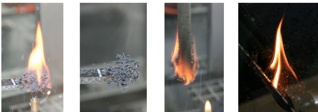
Abbildung 4-40: Brandtest horizontal und vertikal mit 20 m% Blähgraphit in Leinölepoxidharz 99310 ohne Orangenöl -Zusätze
