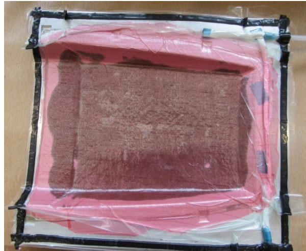
Abbildung 4-54: Vakuumaufbau zur Herstellung des Demonstrator-Bauteils
