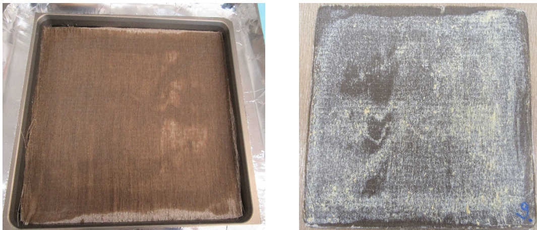
Abbildung 4-30: Herstellprozess einer NFK-Platte mit Harzsystem 99410; Links: Imprägnierung in der Form des Pressenwerkzeugs; Rechts: Oberfläche der entformten Platte nach Aushärtung
