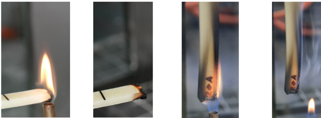
Abbildung 4-39: Brandtest horizontal und vertikal mit 20 m% Ammoniumpolyphosphat in Leinölepoxidharz 99310 ohne Orangenöl-Zusätze
