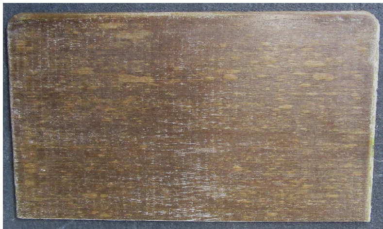
Abbildung 4-42: Flachsfaserverstärkte Platte mit Basisharz-System 99310 und 10 m% APP, Feststoff-Ansammlungen an den Plattenoberflächen
