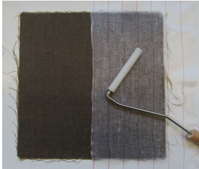
Abbildung 4-33: Herstellung eines Naturfaserlaminats mit der Matrixvariante 99310 im Handlaminat
