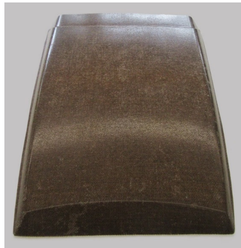
Abbildung 4-55: Demonstrator Lufthutze, bestehend aus dem biogenen Matrixsystem 99310 mit einem Masseanteil von 10 m% Limonen-Epoxid, Faserverstärkung: 3 Lagen Flachsgewebe
