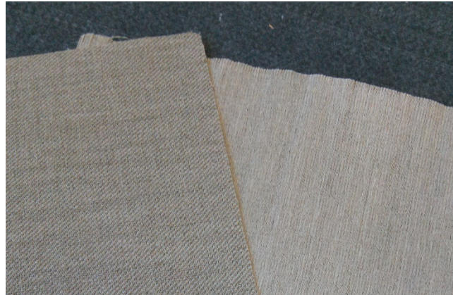
Abbildung 4-22: Darstellung der Flachsfaserhalbzeuge; Links: Flachswebgewebe der Firma Flaxco; Rechts: UD-Gelege der Firma Bcomp
