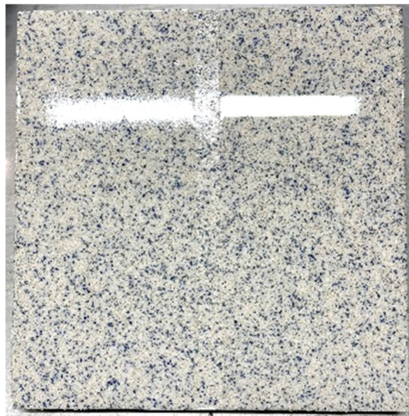
Abbildung 4-47: Prüfkörper für die Beurteilung der Oberflächenbeschichtungen, Mischung 99310 ohne (links) und mit 25 m% LDO (rechts), Mitte: Referenzharz
