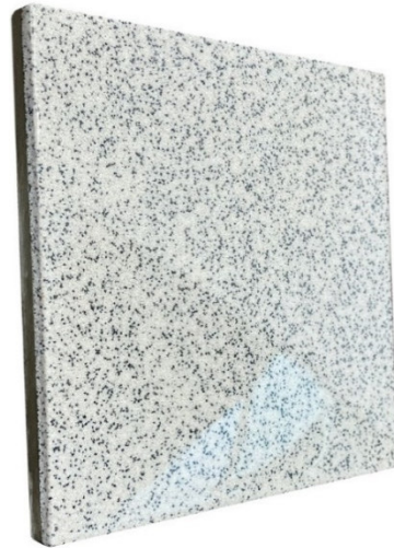
Abbildung 4-52: Bodenbelagsdemonstrator mit dem Leinölepoxidharz 99310 und 25 m% LDO. Der Meilenstein „Demonstrator für Bodenbeläge“ wurde erfolgreich abgeschlossen.
