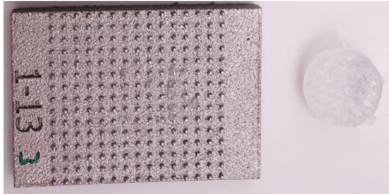
Abbildung 39: Bruchbild einer PC-Probe. Der Kunststoff versagt teilweise im Bereich der PIN-Struktur im Grundmaterial.
