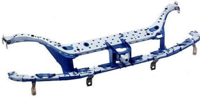
Bild 1: Hybrider Leichtbau am Beispiel eines Front-Ends [15].
