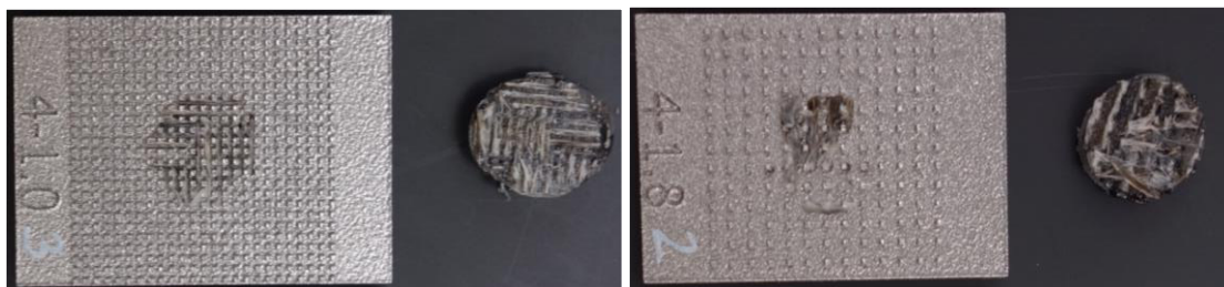
Abbildung 52: Bruchbilder der Fügeverbindungen für PA6-Organoblech bei 1,0 mm Strukturabstand (links) und 1,8 mm Strukturabstand (rechts).
