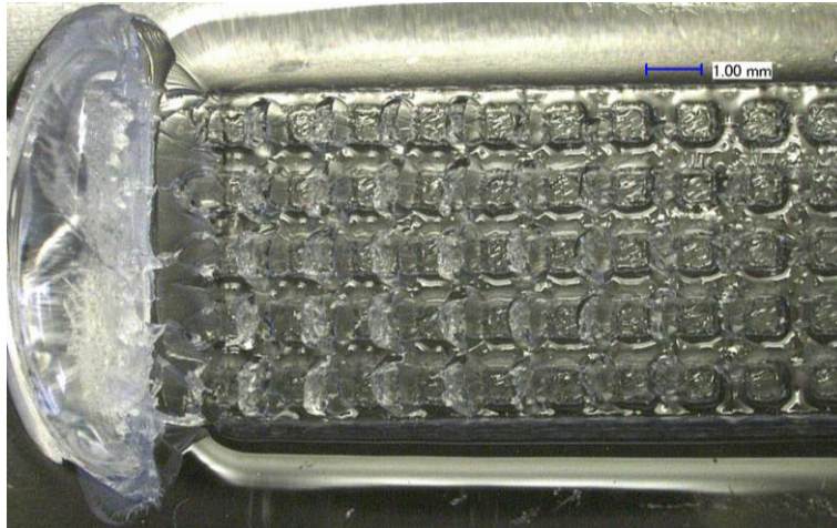
Abbildung 58: Bruchbild einer PC bei 90°-Belastungsrichtung bei der der Wulst an der linken Seite zum Teil ausgebrochen ist.
