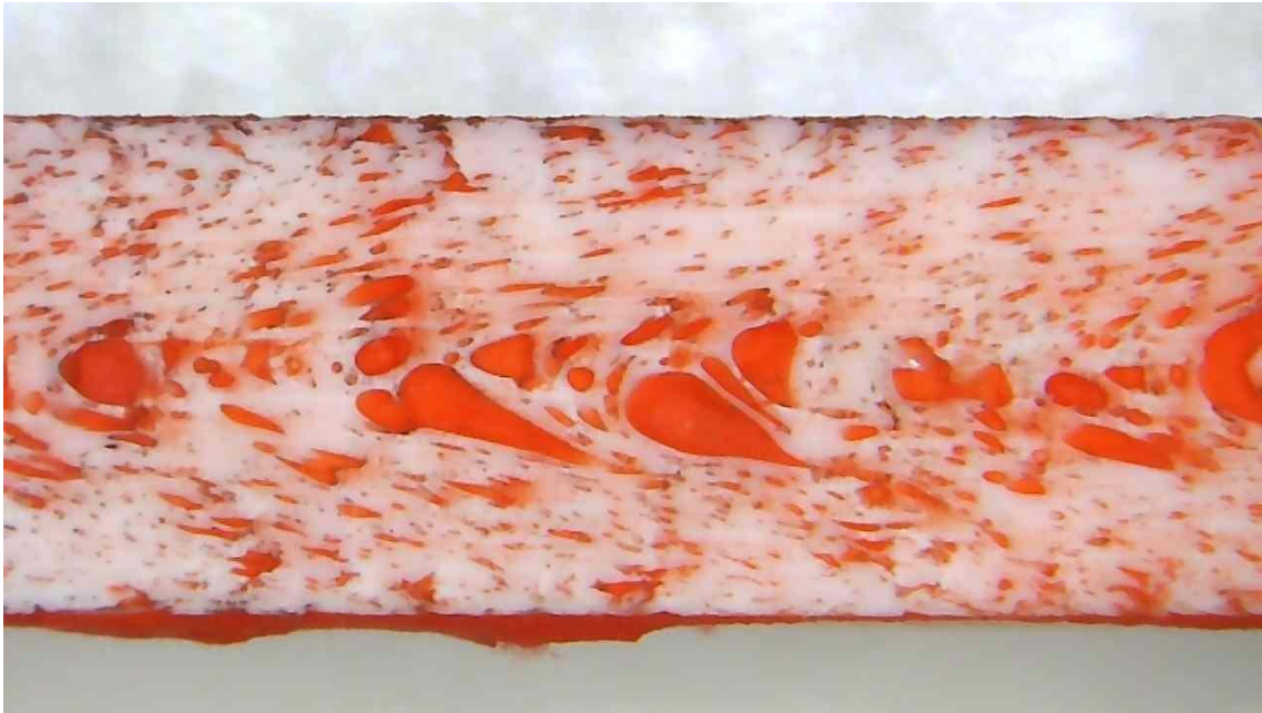
Abbildung 28: Scan einer ABS-Probe mit Acrylfarbe als Porenfüllung
