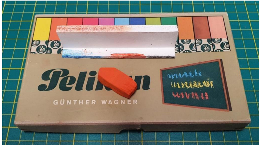
Abbildung 25: Porenfüllung mit Tafelkreide.
