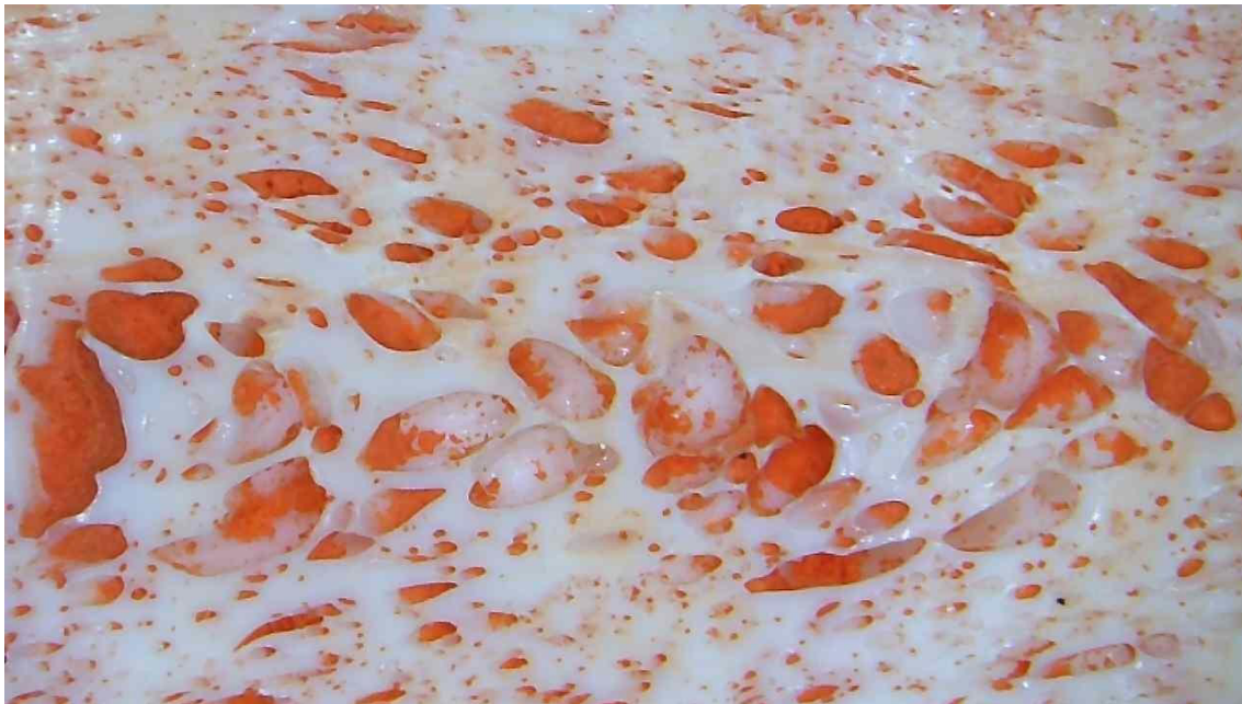
Abbildung 27: Scan einer ABS-Probe mit Kreide als Porenfüllung
